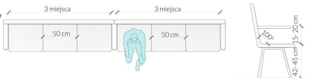
Rys. 29 Wytyczne i wymiary dotyczące ławek
